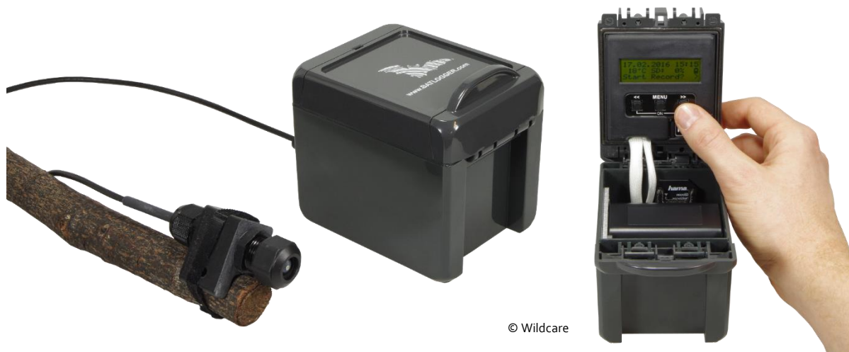
Figure 1 : Enregistreur automatique Batlogger A+
